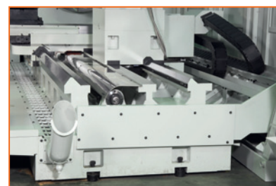
Станина с 3-х кратной конструкцией направляющих по оси Z
